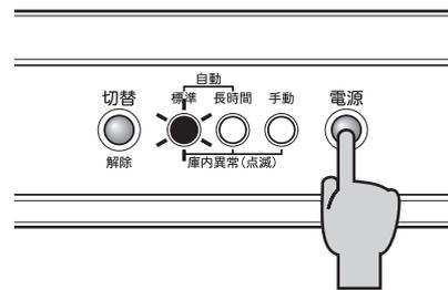
2 炊飯や湯沸しが終わったのち（電力が約250W以下に落ちたときから）、約20分で蒸気排出ユニットの運転が自動的に止まります。
